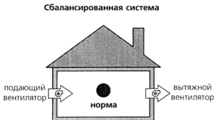
Рис. 8.3. Принудительная вентиляция и давление воздуха внутри дома.
